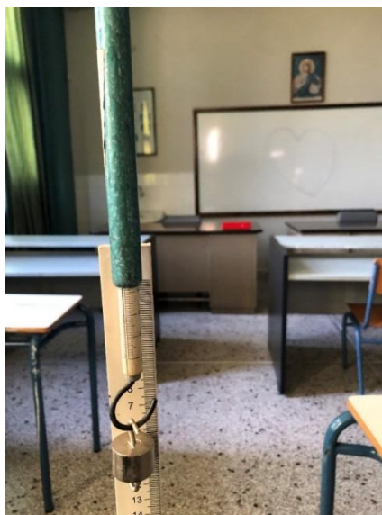
Σχήμα 5: Κοντάρι με μεζούρα, με επιμήκυνση μετά την προσθήκη βαριδίου
